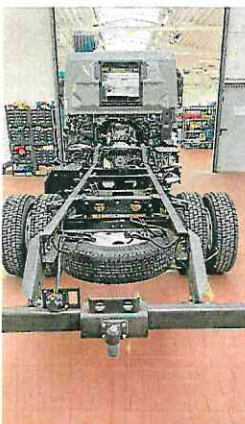
Ein Fahrgestell in der Wilde-Werkstatt, bereit dafür, dass der Kabinenaufbau beginnt.
